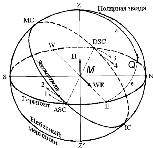
рис. 1. Изображение небесной сферы в местной горизонтальной астрономической системе координат (ГАСК). M – точка, где находится наблюдатель на земной поверхности; Z, Z' – зенит и надир, соответственно; N, S, W, E – точки севера, юга, запада и востока, соответственно; H – единичный вектор местной вертикали; WE – единичный вектор местного направления запад-восток; NZSZ' – местный небесный меридиан; NWSE – линия местного горизонта; Q – точка небесной сферы; ZQ \equiv z – зенитное расстояние z точки Q ; EQ \equiv e – восточное расстояние e точки Q ; ASC – асцендент – восточная точка пересечения эклиптики и линии местного горизонта; DSC – десцендент – западная точка пересечения эклиптики с линией местного горизонта; MC, IC – верхняя и нижняя точки
