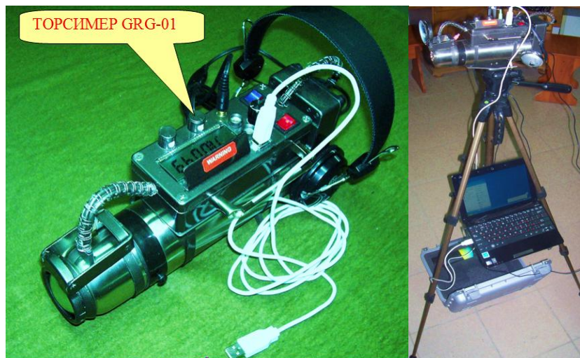
Рисунок 2 - Торсимер для автономных работ GRG-001 (крупно и в полной комплектации)
