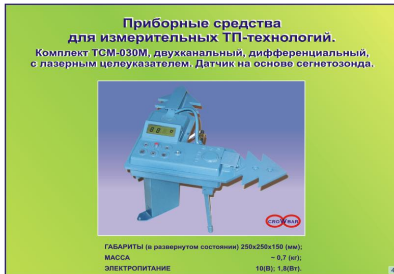
Рисунок 1 - Торсимер ТСМ-030 в развёрнутом состоянии.
