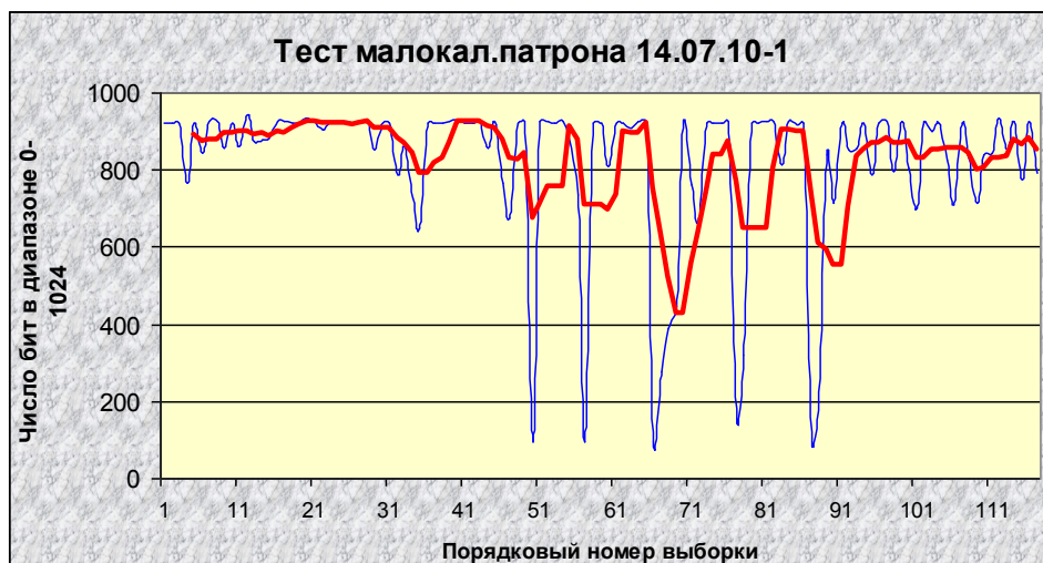
Рисунок 3 - Реакция комплекса GRG-001 на снаряженный малокалиберный патрон с расстояния 3м. Движение зонда имеет поперечную составляющую.
